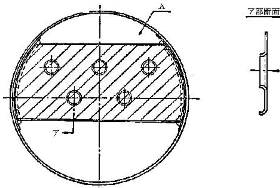
注 防波板の面積（斜線部に設けた穴がA部断面に示すような補強を考慮した構造である場合はその面積を含む。）は、容器の横断面積の40%以上であること。
