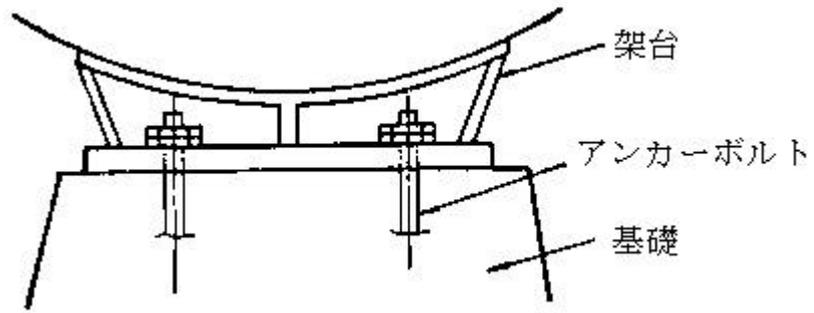
(5) 横置円筒形貯槽の架台の支持間隔（スパン）が5m以上のものにあつては、当該貯槽の遊動側の架台に対し基礎据付面と架台底面との間に次のイ、ロ、ハに定めるすべり板を設けること。
