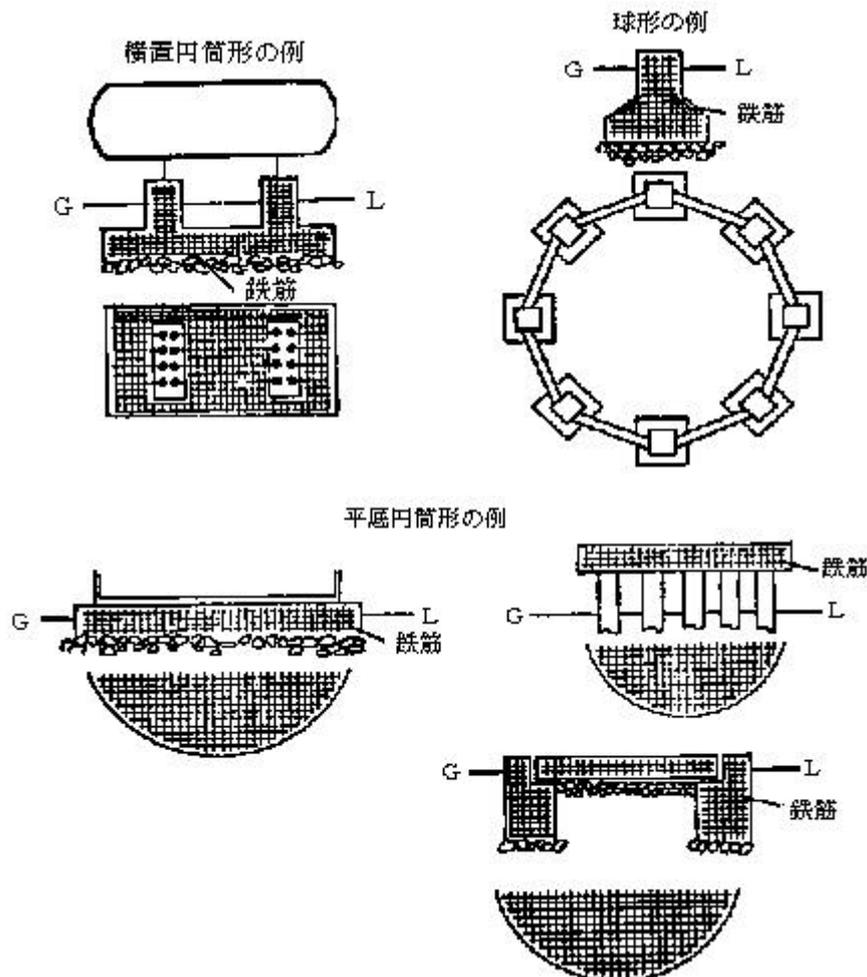
8.2 貯槽を基礎に緊結する方法は、次の基準の例によるものとする。
