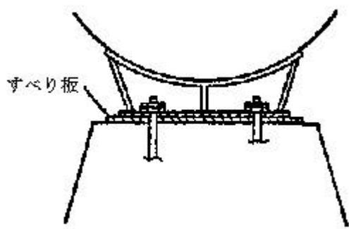
(6) 球形貯槽のアンカーボルトの取付けは、次の図に示す例により行う。
