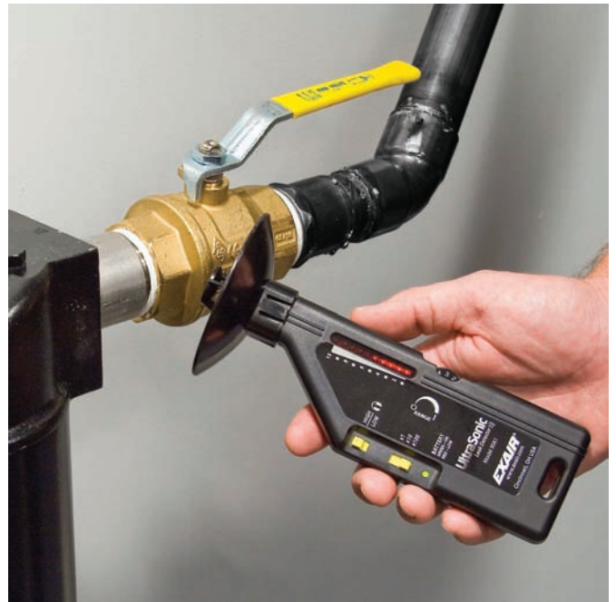
Model 9061超音波リークディテクタ(ULD)は雑音の多い工場内でリークをピンポイントで素早く検出します。
