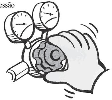
**Verificar se é possível alcançar até a pressão máxima com a alavanca do ajuste de pressão.**
